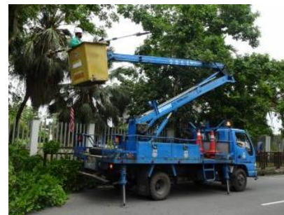
Gambar 25 : Jentera sky lift yang digunakan semasa pemangkasan/pencantasan. Sumber : JPBW
