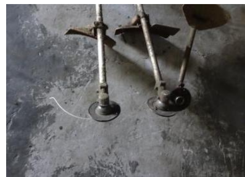
Gambar 36 : Contoh mata pemotong nilon yang perlu digantikan sebelum diguna semula. Sumber : JPBW
