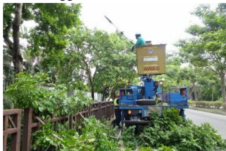
Gambar 30 : Pemangkasan dilakukan dengan menggunakan jentera sky lift Sumber : JPBW
